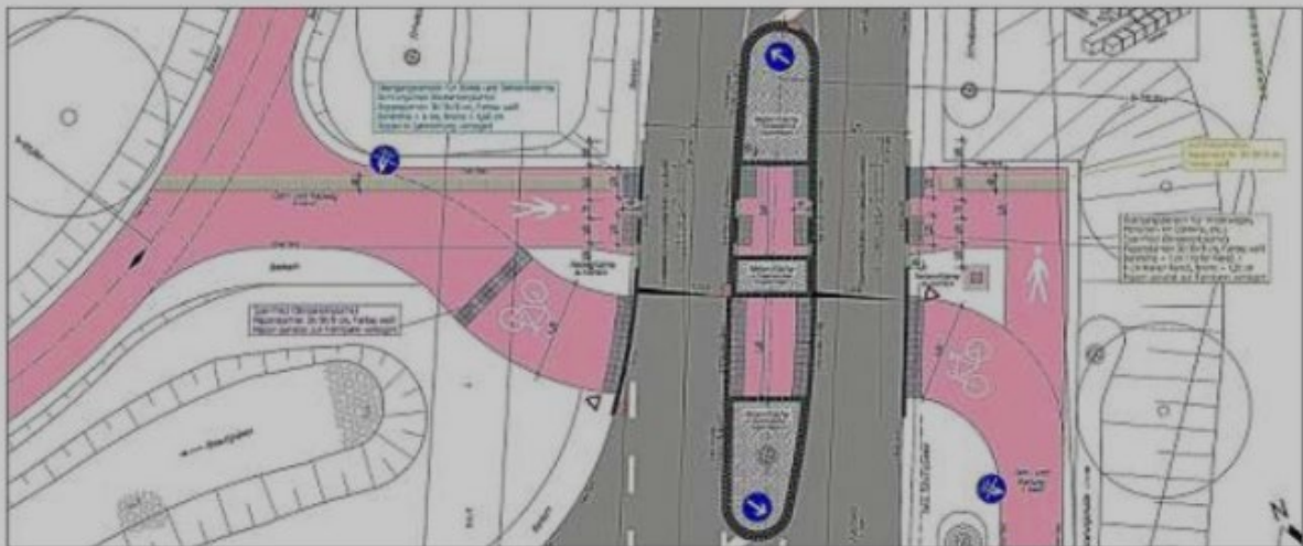
Eine Querungshilfe der Extraklasse erklärt Andreas von Dobschütz vom Staatlichen Bauamt (oben). An dieser Stelle werden Radler und Fußgänger sauberlich getrennt die Staatsstraße kreuzen. Für die Fußgänger ist der Zugang behindertengerecht abgeflacht. Fotos: Auer, Bauamt
